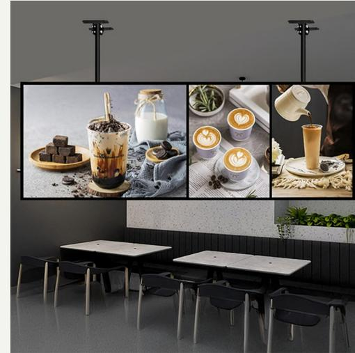
Este tipo de panel está elaborado en aluminio y vidrio templado de calidad altamente resistente. Se encuentra disponible en color negro y viene con rendija para insertar y extraer hojas de papel backlight film, generando un efecto increíble de brillo. Está fabricado para quedar suspendido en techos o superficies que cumplan con las condiciones para su exhibición. Incluye fuente de poder y kit de instalación con barra metálica.
